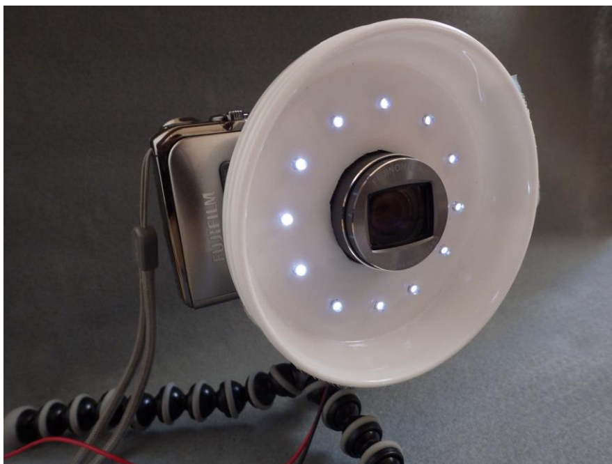
自作接写撮影用 LED 照明(デジカメ:FUJIFILM FINEPIX F300EXR)
